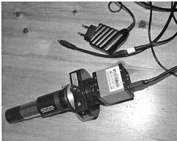
Abb. 3: Anschluss der DMK an Fernrohr und Computer: Die Kamera ist über einen C-Mount-T2-Adapter an eine Filterschublade (Neumann) angeschraubt. Der Brennweitenverlängerung diente eine 2x-Barlow-Linse (Celestron). In dieser Konfiguration erreicht die Kamera das Nyquist-Theorem an einem f/10 SCT.
