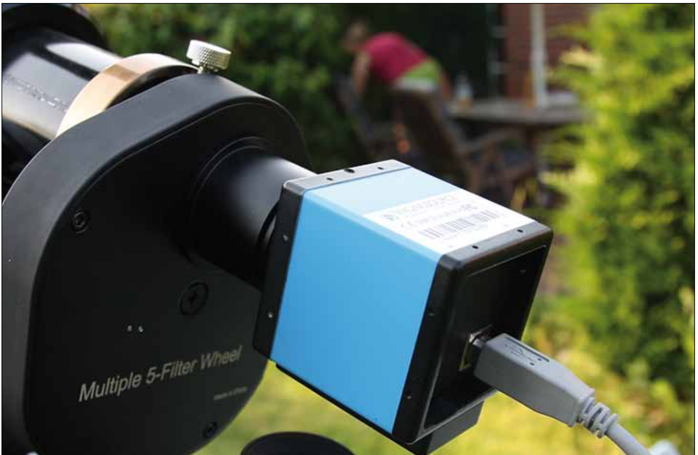
Abb. 3: CCD-Kamera von TIS mit Filterrad am ED70-Refraktor.
