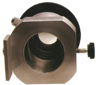
Dieser selbst gefertigte Kamerahalter ermöglicht einen sekundenschnellen Wechsel zwischen der Schwarz-Weiß- und der Farbkamera. Zur Anpassung des Verlängerungsfaktors ist im Inneren eine verschiebbare Barlowlinse angebracht.
